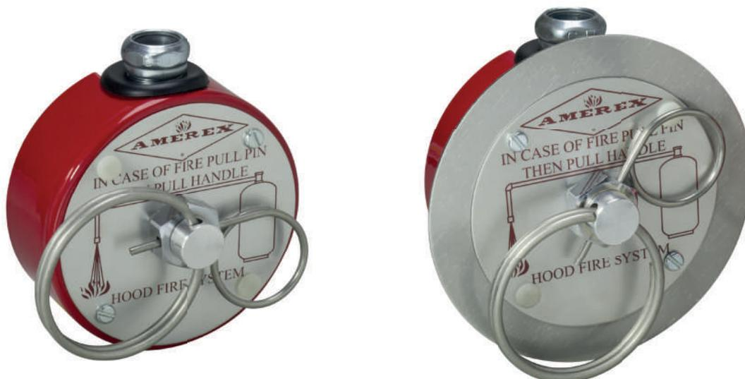
O acionador manual permite que qualquer pessoa acione manualmente o sistema, caso perceba um princípio de incêndio antes do sistema de detecção de temperatura. O acionador manual deve ser instalado em local de fácil acesso para facilitar sua atuação quando for necessário.
