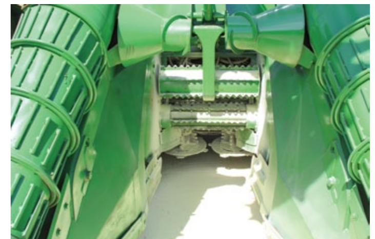
Vista frontal (corte de base) após a descarga do agente extintor
