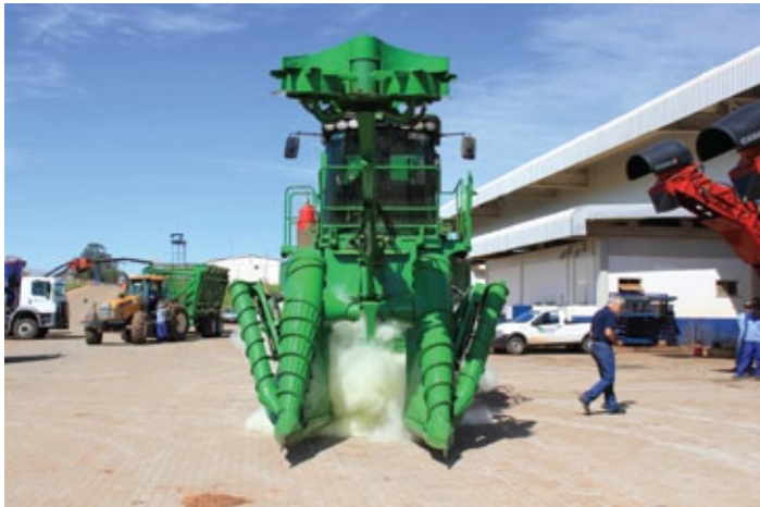
Automaticamente o painel envia um sinal de comando elétrico, que desencadeia a descarga do agente extintor
